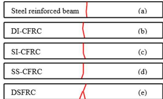
**Fig. 7.** Crack pattern of (a) steel reinforced beams, (b) DI-CSFRC, (c) SI-CSFRC, (d) SS-CSFRC, and (e) DSFRC beams.
